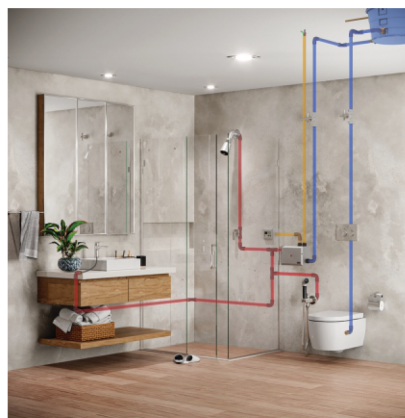
FIG 3 - INSTALAÇÃO HIDRÁULICA COM TUBULAÇÃO DE ÁGUA QUENTE E FRIA
