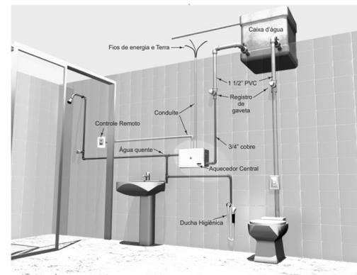
FIG 3 - INSTALAÇÃO HIDRÁULICA COM TUBULAÇÃO DE ÁGUA QUENTE E FRIA
