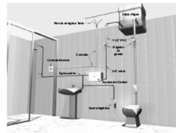
FIG. 3 - INSTALAÇÃO HIDRÁULICA COM TUBULAÇÃO DE ÁGUA QUENTE E FRIA
