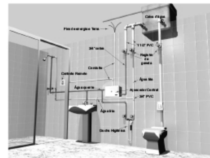
FIG. 3 - INSTALAÇÃO HIDRÁULICA COM TUBULAÇÃO DE ÁGUA QUENTE E FRIA
